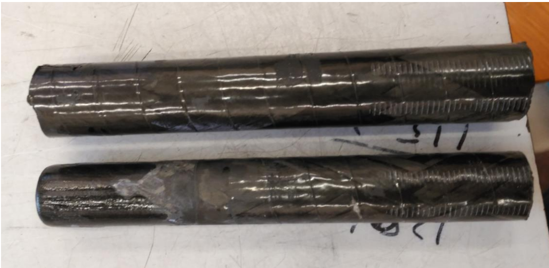
Figura 39. Estado de unas de las parejas de tubos después del ensayo.
