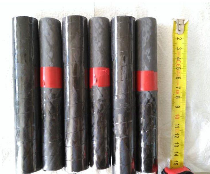
Figura 33. Longitud de pegado de los tubos.
