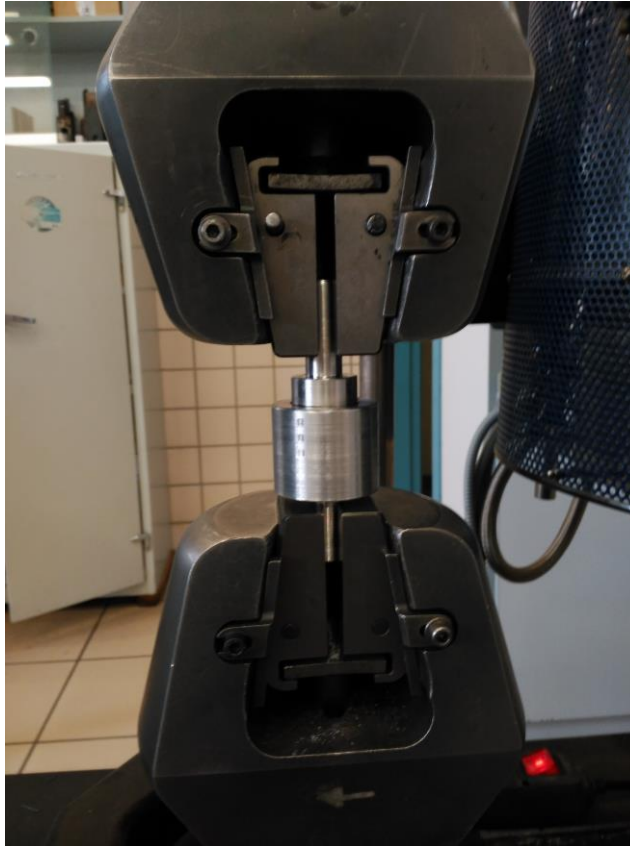
Figura 40. Ensayo de las probetas de aluminio en la máquina del departamento.
