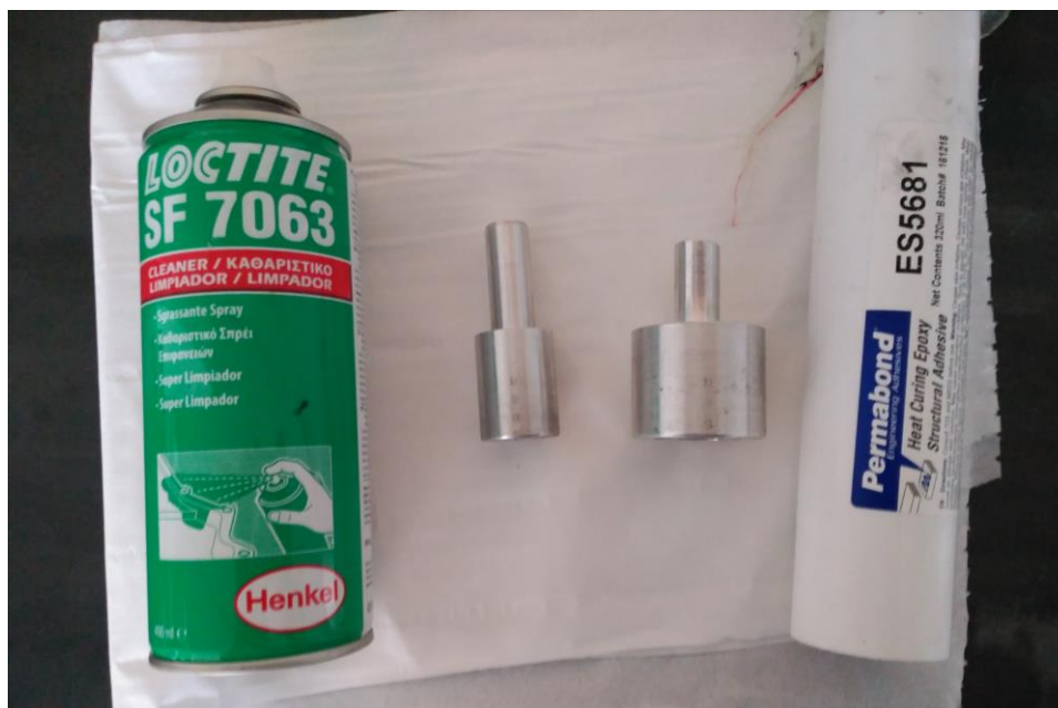
Figura 37. Las dos probetas a pegar con el limpiador Loctite SF 70993 y el adhesivo ES5681.
