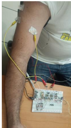
Figura 17.- Ubicación de electrodos para medida de pathloss
