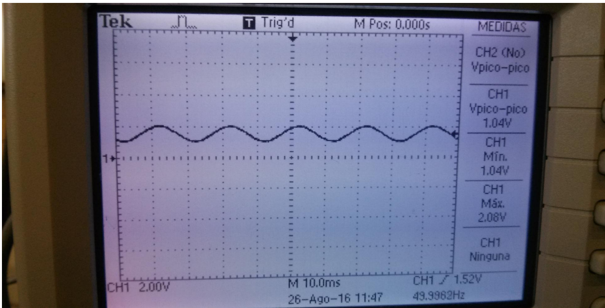
Figura 41. Salida del osciloscopio del circuito de intensidad con batidora.
