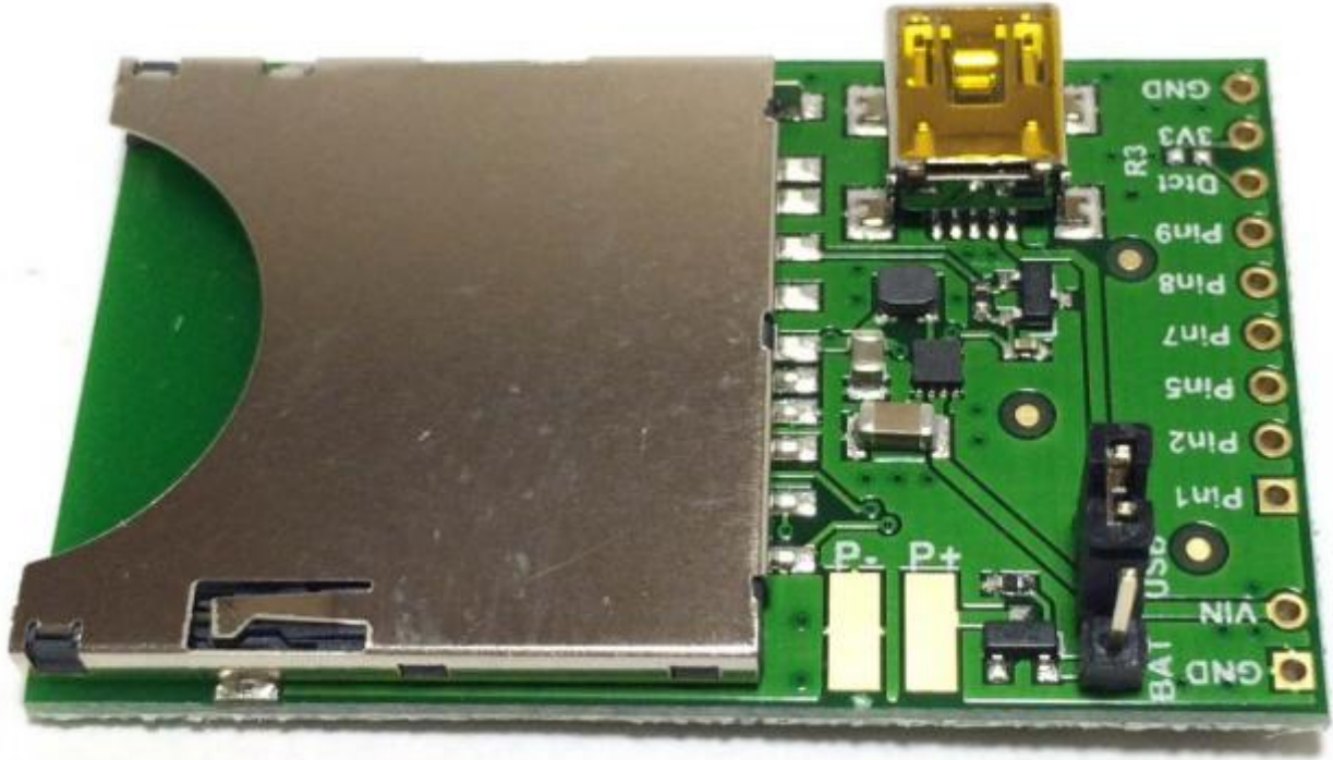
Figura 6. Placa para usar Imp001.
