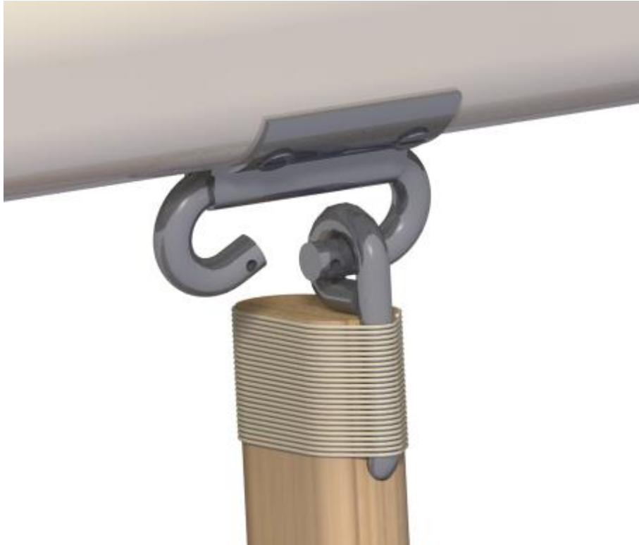
Ilustración 5-74: Conexión de una riostra con su fijación
