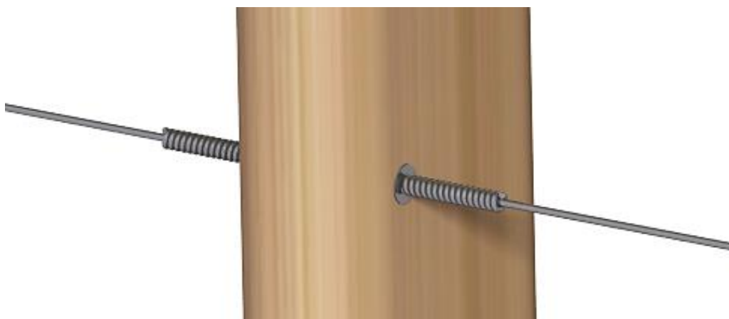
Ilustración 5-79: Alambre horizontal atravesando a una riostra
