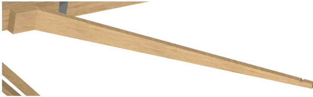
Ilustración 5-47: Soporte del extremo derecho de la estructura del ala inferior
