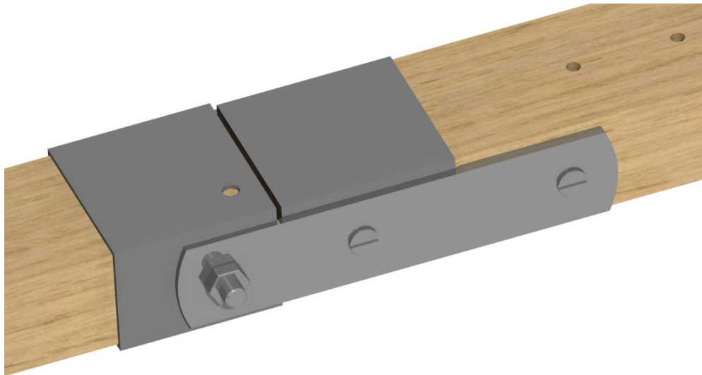
Ilustración 5-57: Unión de los largueros traseros central e izquierdo
