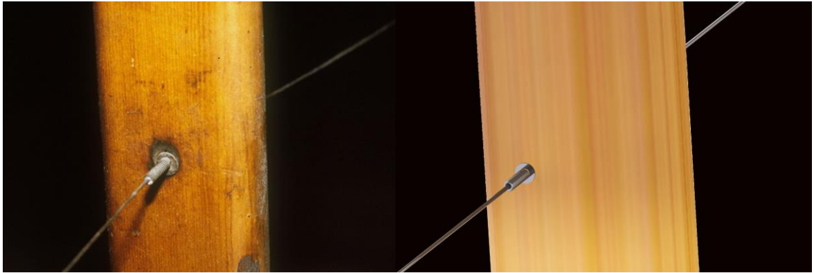
Ilustración 6-3: Comparación del alambre horizontal real (38) con su modelo
