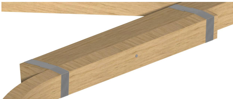
Ilustración 5-48: Unión del listón curvo derecho con el larguero trasero inferior
