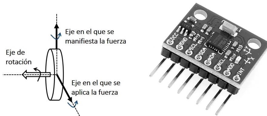
Figura 3.23: Esquema giroscopio y giroscopio MPU-6050 de 3 ejes compatible con Arduino, de empresa Oem
