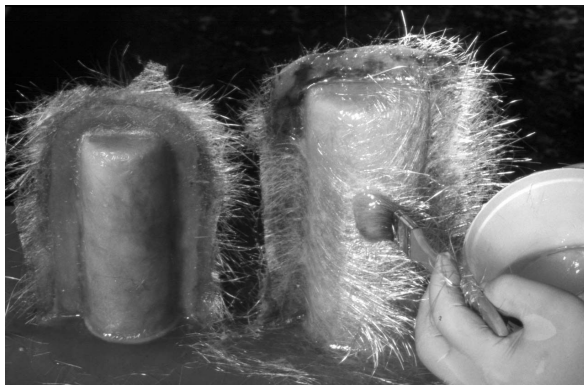
Lám. 4: Conformación de la madreforma mediante estratificación de resina y fibra de vidrio en ambos Ídolos.
