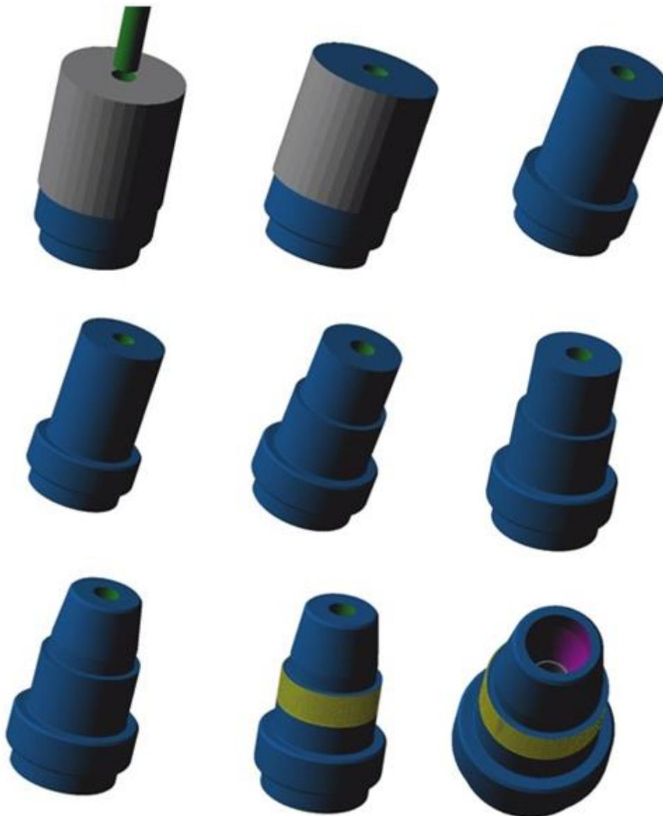
Figura 4.41 Resumen fase 2 de mecanizado de la pieza 4.
