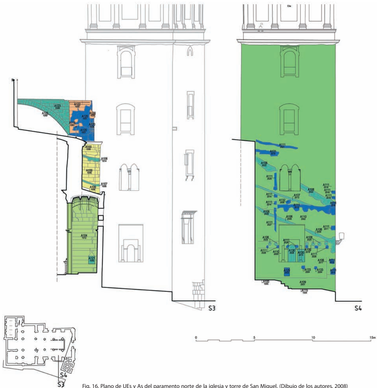
Fig. 16. Plano de UEs y As del paramento norte de la iglesia y torre de San Miguel. (Dibujo de los autores, 2008)
