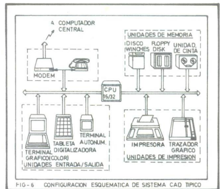
FIG-6 CONFIGURACION ESQUEMATICA DE SISTEMA CAD TÍPICO
