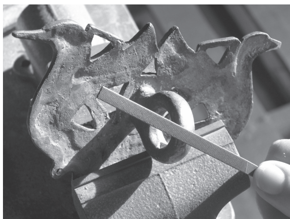
Lám. 41: Corrección de las superficies del modelo del Bronce Carriazo donde se fijaron los bebederos en la cera.
