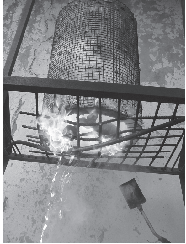
Lám. 20: Eliminación de la cera en la campana mediante el "choque térmico".
