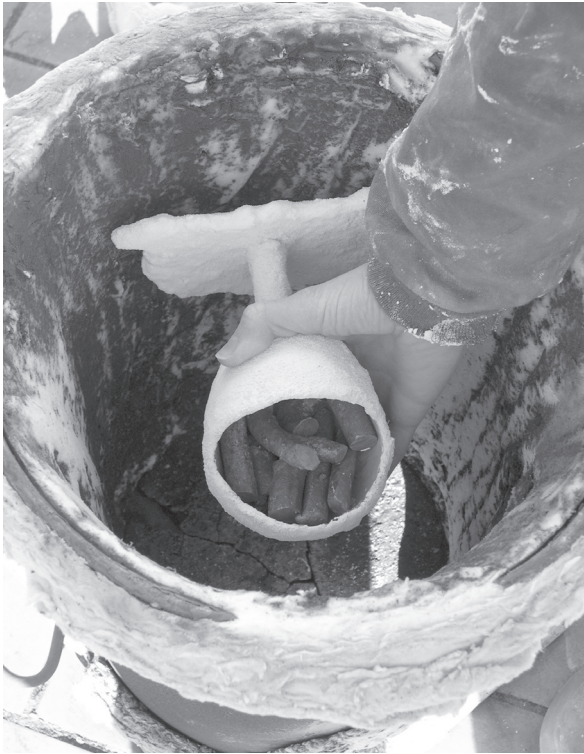
Lám. 27: Introducción del molde en el horno de fusión.
