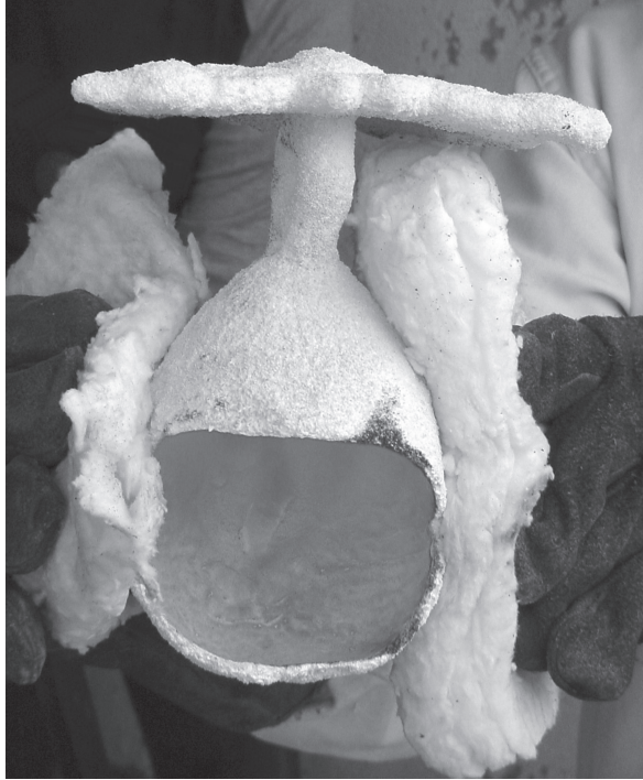
Lám. 22: Vista del conjunto cerámico; modelo, bebederos y crisol una vez evacuada la cera.
