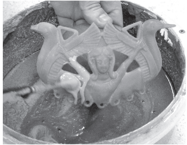
Lám. 14: Aplicación a pincel del primer estucado refractario sobre el Bronce Carriazo.
