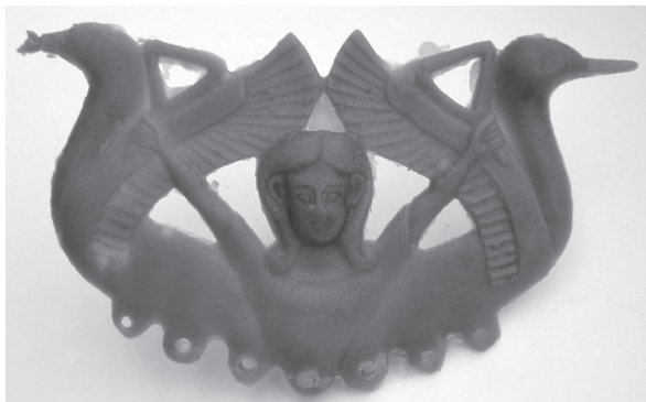
Lám. 9: Reproducción en cera del Bronce Carriazo sin reparar. Son visibles las rebabas características de las particiones.
