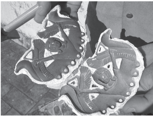
Lám. 36: Detalle de la imagen anterior que muestra la facilidad de separación de la cascarilla en aquellas zonas planas poco texturadas, la reducida sección del molde cerámico, y el ennegrecimiento superficial por oxidación que presenta el bronce (la figura del fondo).
