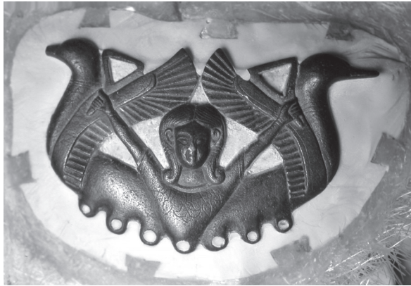
Lám. 4: Mitad posterior del molde ya configurada.
