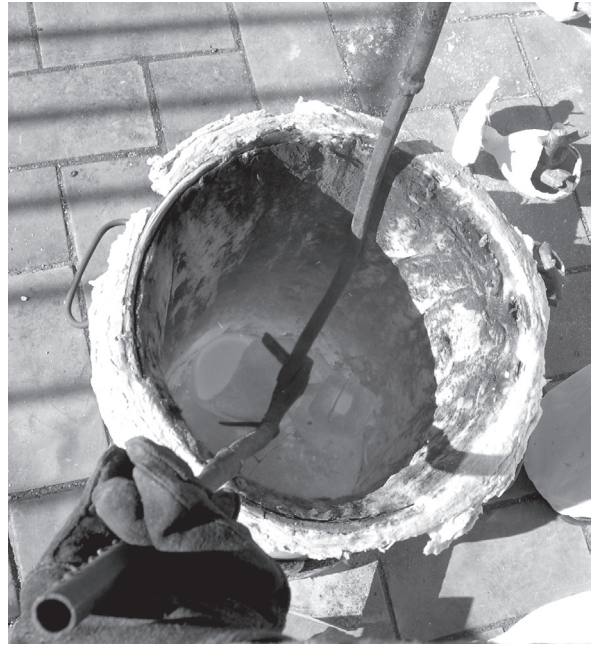
Lám. 29: Secuencia 1 de la extracción del molde por medio de una pinza del horno.
