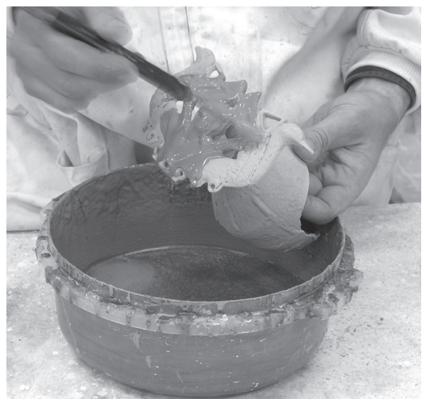
Lám. 16: Una vez seca se reviste de la segunda capa el modelo de cera del Carriazo.
