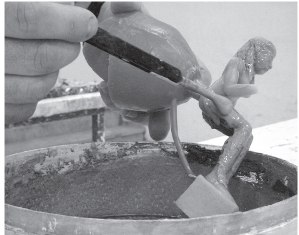
Lám. 15: Aplicación a pincel del primer estucado refractario sobre la Astarté.
