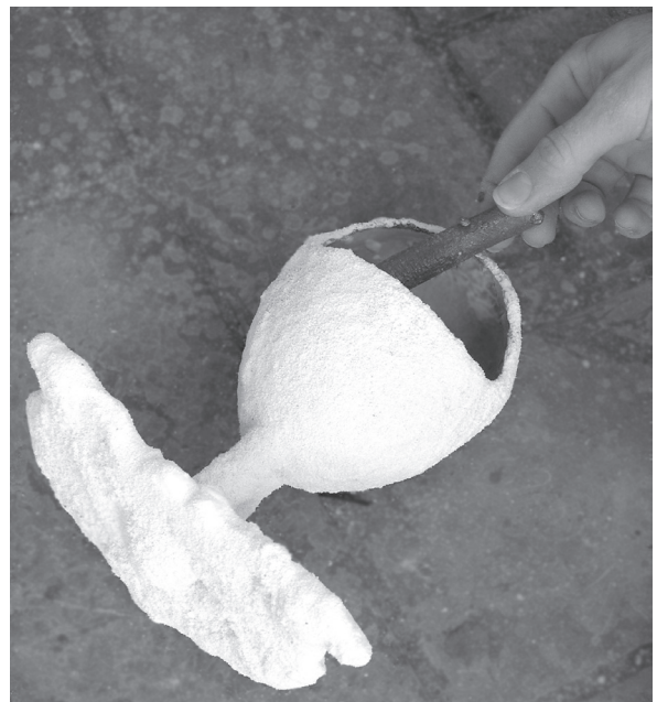
Lám. 26: Incorporación de trozos de bronce al crisol del Carriazo.
