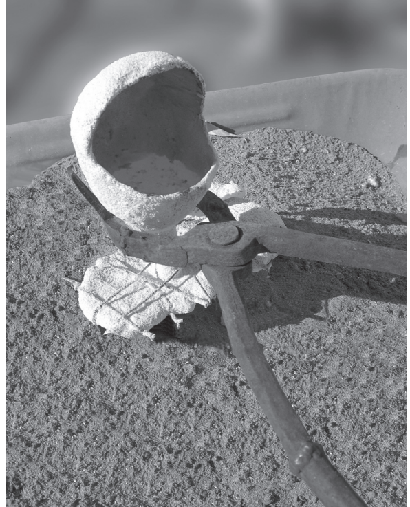
Lám. 33: Secuencia 5, la pieza se asienta en la arena hasta que el metal enfríe.
