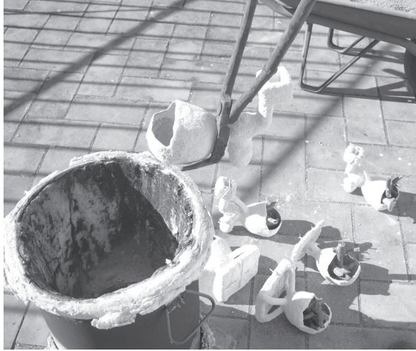
Lám. 31: Secuencia 3 de dicha maniobra donde se traslada el conjunto a un lecho de arena.
