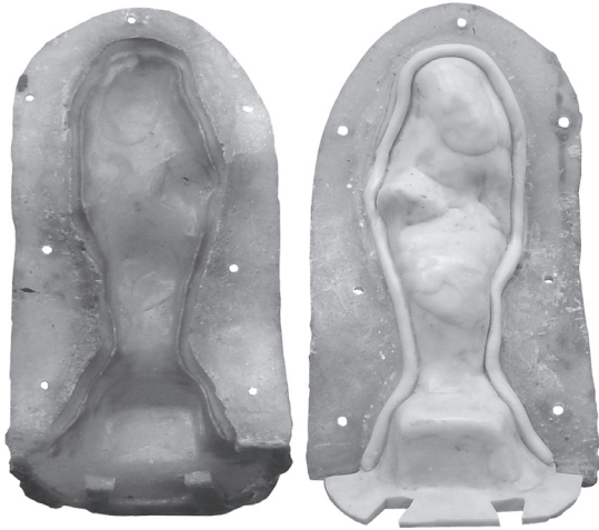
Lám. 12: Detalle del molde de la Astarté que muestra sus componentes: Negativo flexible (silicona), y madre forma rígida (resina de poliéster).
