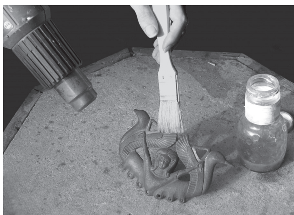
Lám. 42: Pátina por oxidación superficial a través de la acción de ácidos acelerada con calor.
