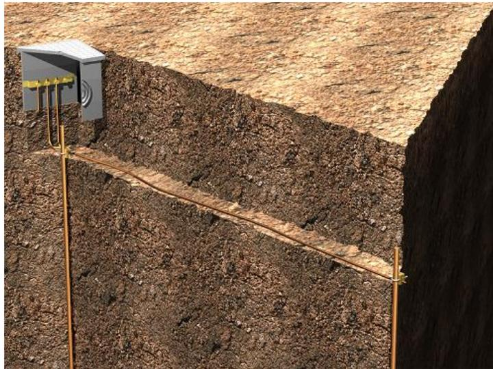
Figura 42. Puesta a tierra mediante picas y conductores [21]
