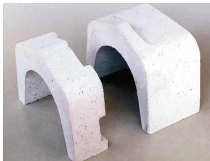
Figura 29. Deflector cerámico de dos partes [48]
