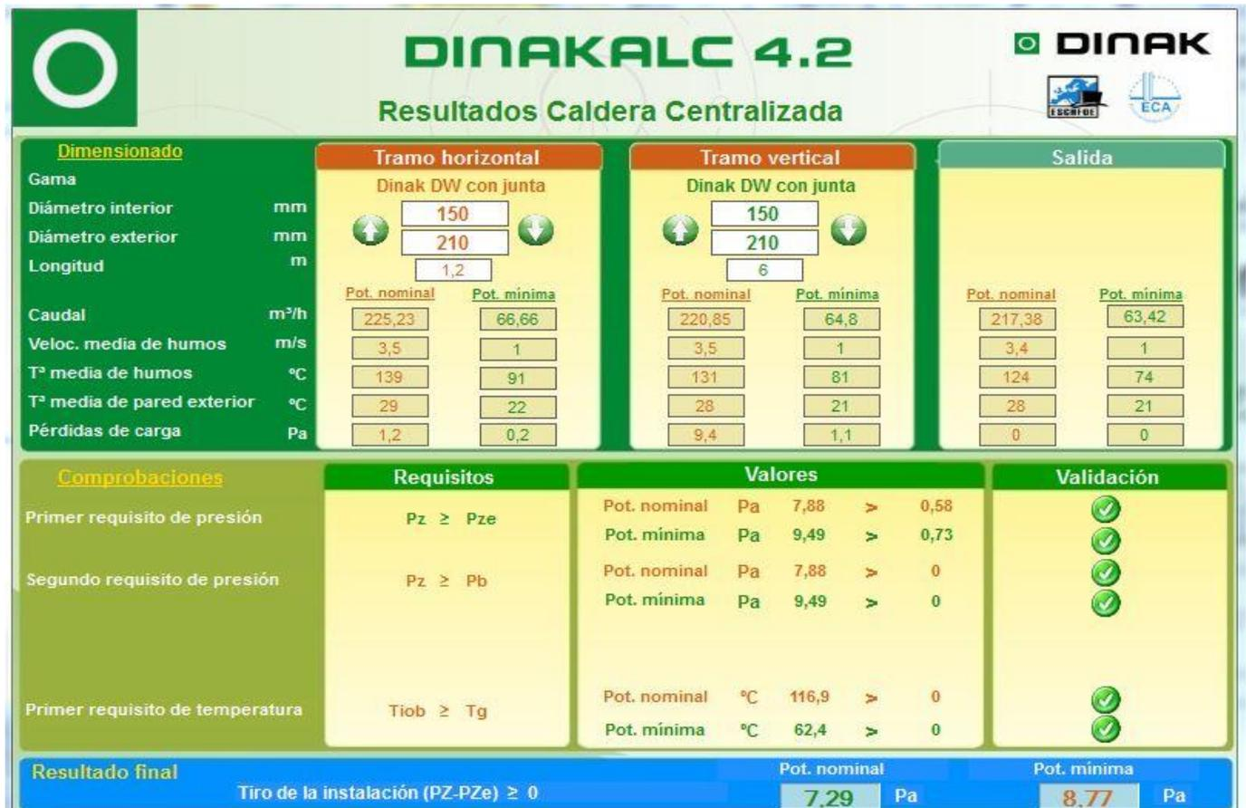
Figura 43. Resultados del cálculo del diámetro de la chimenea [20]
