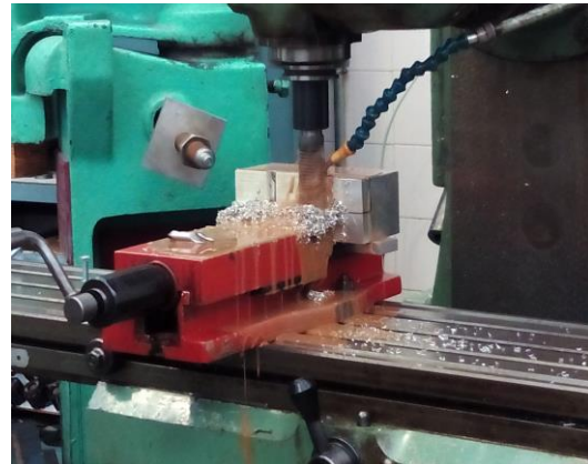
Figura 3-16. Mecanizado del escalón
