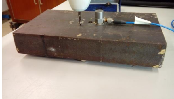
Figura 3-14. Prueba para determinar la frecuencia del excitador
