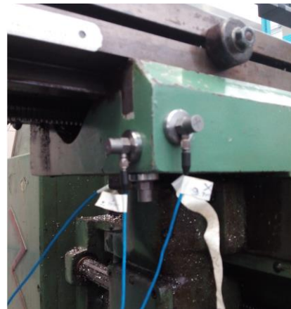
Figura 3-19. Acelerómetros en dirección longitudinal, transversal y vertical
