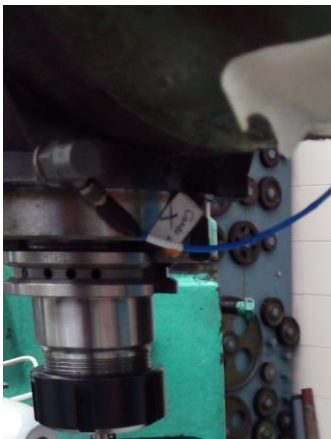
Figura 3-18. Acelerómetro ubicado en el husillo
