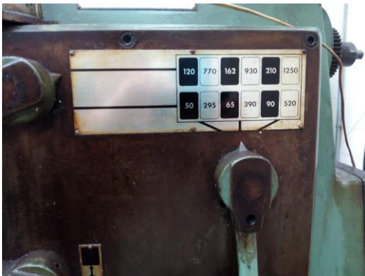
Figura 3-11. Velocidades de giro fresadora CM-60
