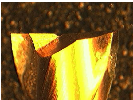
Figura 3-23. Estado de la herramienta al finalizar los ensayos
