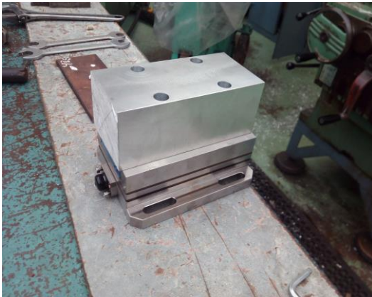
Figura 3-15. Pieza inicial con los cuatro agujeros
