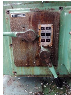
Figura 3-12. Velocidades de avance fresadora CM-60
