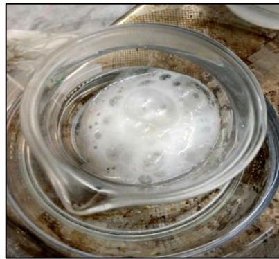
Figura 9. Flotación del comprimido del lote 11 a los 15 minutos de empezar el ensayo de flotabilidad
