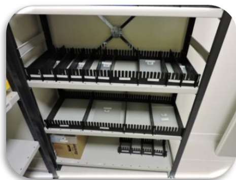
Ilustración 8: Estantería de una unidad clínica con sistema Kanban elaborado con peinas de plástico
