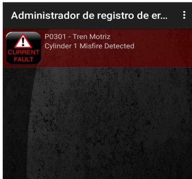
Fig. 81 – Simulación del DTC 1
