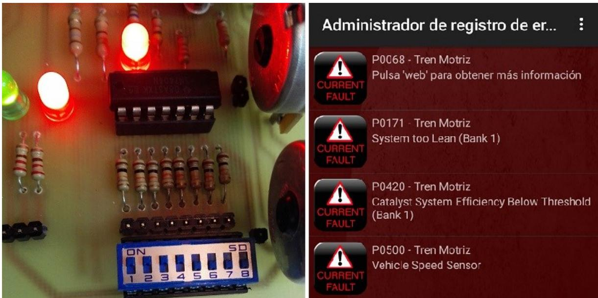
Fig. 84 – Simulación de los DTCs 4, 5, 6 y 7
