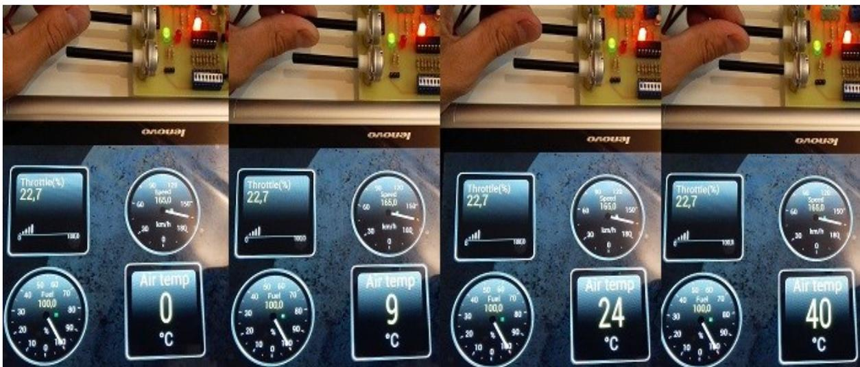
Fig. 76 – Simulación del parámetro Air temperature (temperatura ambiente)
