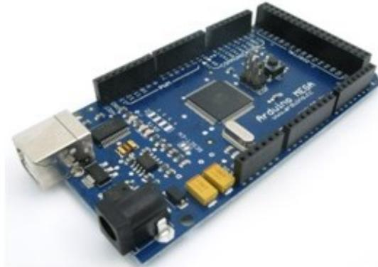
Fig. 33 – Arduino MEGA
