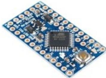
Fig. 31 – Arduino PRO Mini
