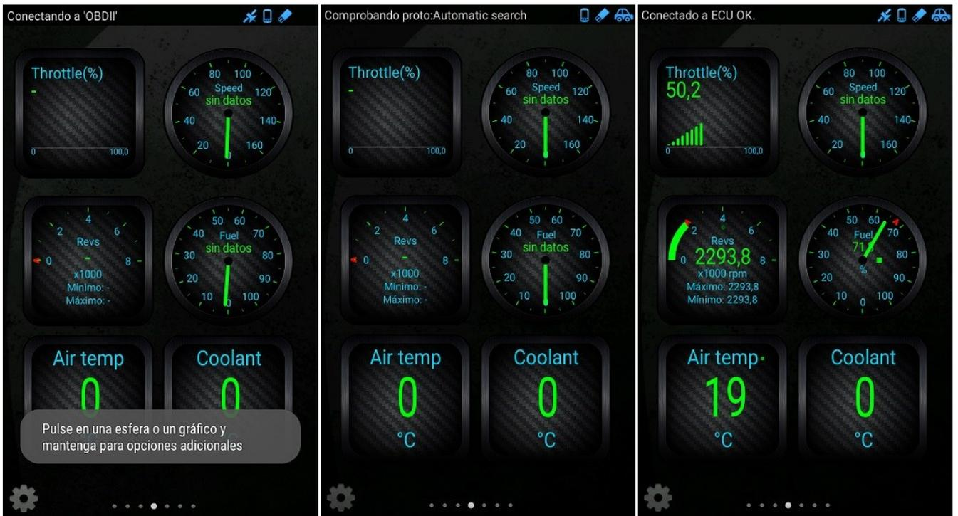
Fig. 69 – Simulación de la inicialización del protocolo ISO9141-2
