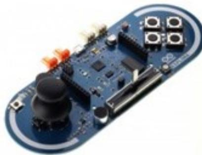
Fig. 38 – Arduino Esplora
