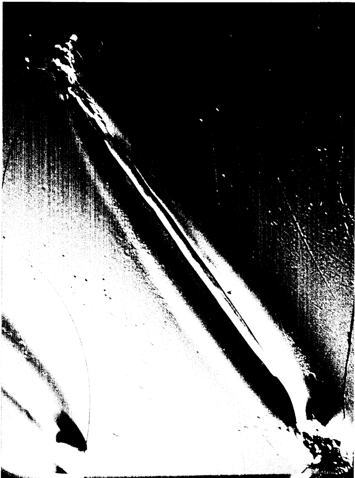
Fig. 4.44 Micrografía obtenida con microscopía electrónica de barrido, de un filamento de memoria incompleto. El aumento de la micrografía es de 180.
