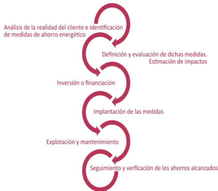
Figura 2: Alcance de un servicio energético. Fuente: EoEnergia
