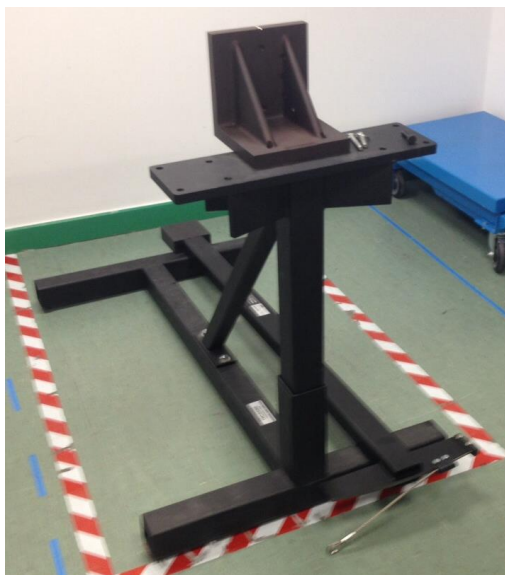
Figura 2-1. Banco de calibración descargado
