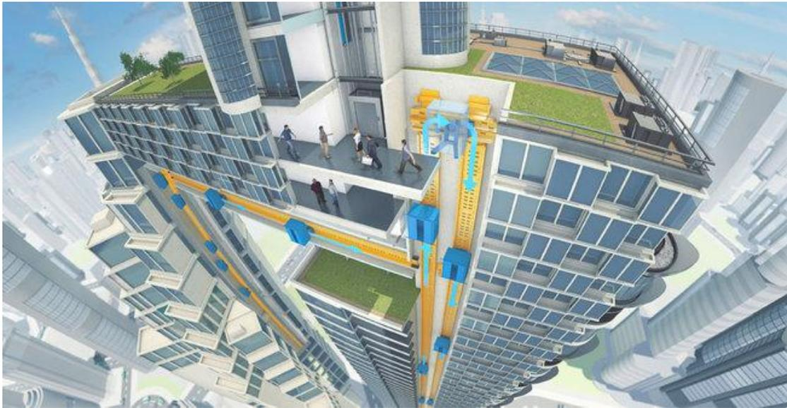
**Figura 12:** Sistema de ascensores multicabina
