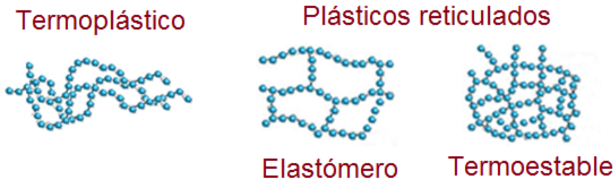
Figura 1.16. Tipos de polímeros según sus entrecruzamientos, termoplástico, plástico reticulado A) Elastómero y B) Termoestable.
