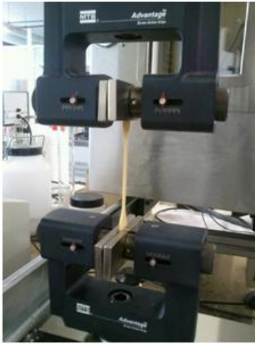
Figura 2.13. La muestra se coloca entre las mordazas las cuales se van separando a una velocidad de 1mm/mm. La probeta va sufriendo una elongación hasta llegar a la tensión máxima que puede aguantar por encima de cual fractura.
