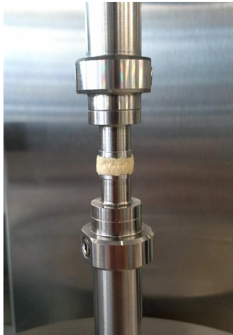
Figura 2.11. Ensayo de compresión de masa en el equipo RSA3 con geometría cilíndrica de 8 mm de diámetro.
