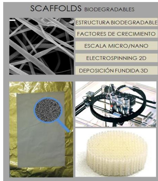
Fig. 23a: Imagen tridimensional de algunas matrices y técnicas de elaboración de andamios poliméricos para ingeniería de tejidos.
