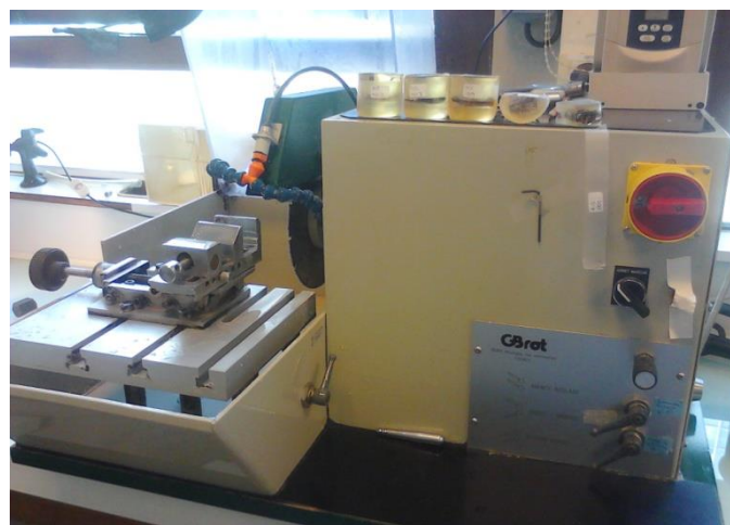
Fig. 45: Corte y tallado de los bloques en sierra hidráulica.
