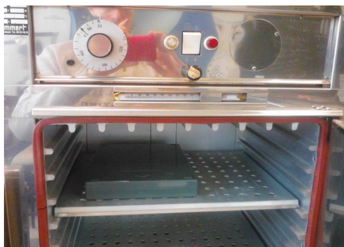
Fig.52: Kit de tinción y estufa de secado para tratamientos enzimáticos (TRAP y ALP).
