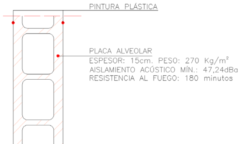
Ilustración 2-3: Detalle del muro de la fachada sur
