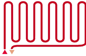
Ilustración 3-7: Distribución en serpentín
