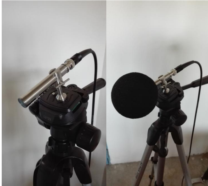
Figuras 2.2 y 2.3. Micrófono empleado para ambos ensayos
