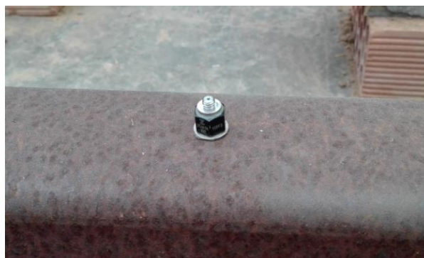
Figura 2.1. Uno de los acelerómetros empleados para el primer ensayo
