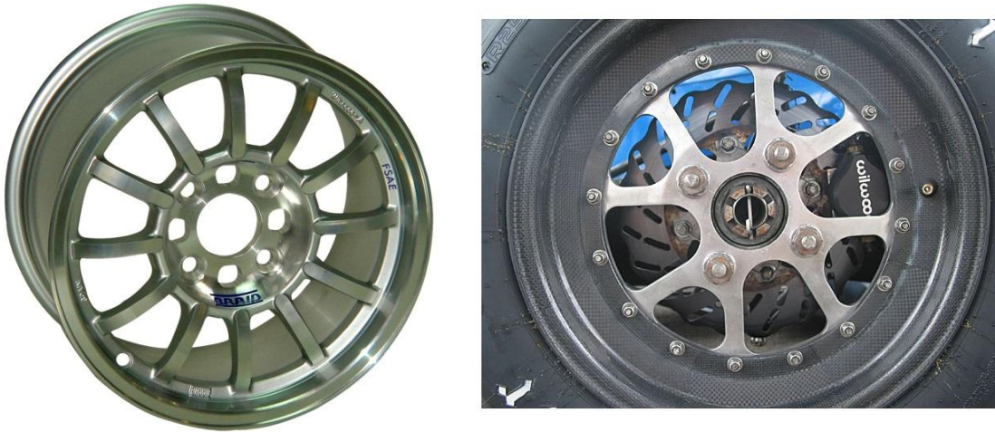
Ilustración 1: Llanta mono pieza (izq.) vs llanta de 3 piezas (estrella de aluminio y aros de carbono)
