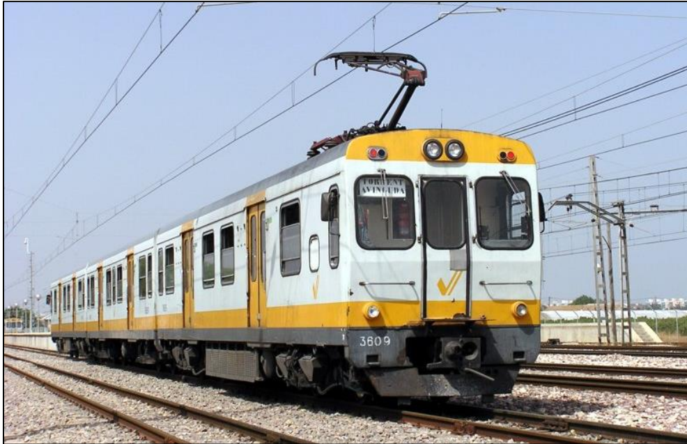
Ilustración 22 Imagen de un vagón en el que se puede apreciar claramente el contacto del pantógrafo con la catenaria
