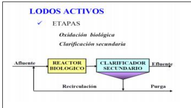
Ilustración 32 Esquema de lodos activos
