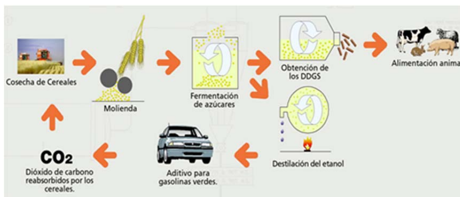
Figura 10. Esquema del proceso de obtención de ecoproteína. Fuente: 2005 - 2007 Abengoa Bioenergía( http://www.abengoabioenergy.com/web/es/index.html )
