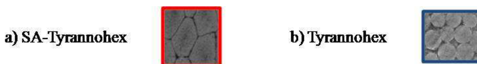
Figura 5.2 Secciones de imágenes SEM representativas de la microestructura de los materiales cerámicos estudiados. a) Micrografía SEM en la que se observa la sección poligonal de las fibras del SA-Tyrannohex interconectadas por la capa de C . b) Sección del Tyrannohex donde se ve la sección circular de las fibras de SiC embutidas en la matriz de SiO 2 .
