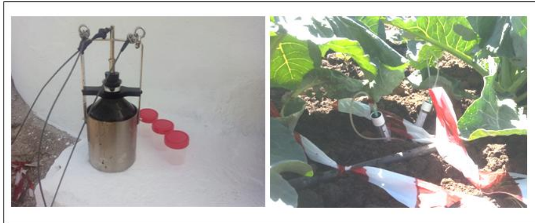
Figura 3. Botella para recogida de muestras de agua en profundidad (izq.). Sondas de succión tipo Rhizon instaladas en parcela experimental (drcha.).
