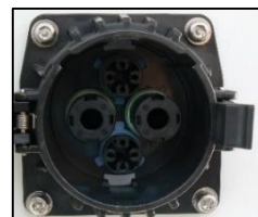
Figura 17. Enchufe conector Tipo 4 (japonés). Fuente: CHAdeMO.
