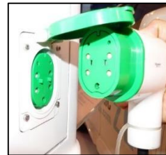
Figura 16. Enchufe conector Tipo 3 (francés). Fuente: LugEnergy.
