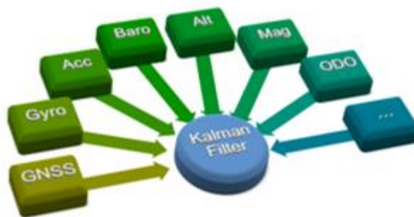
Figura 5-1. KF combinando diferentes técnicas y sensores
