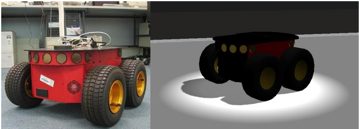
Figura 1-3. Robot móvil, Pioneer 3-AT. a) Modelo real, b) Modelo en Gazebo
