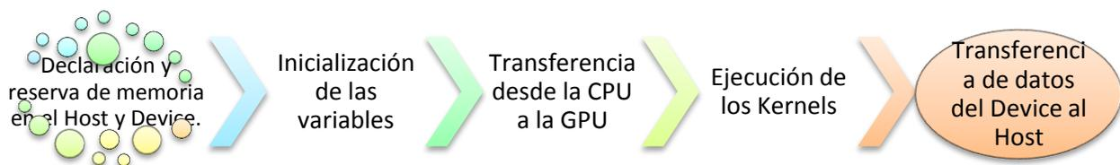
Figura 3.1: Metodología de diseño de algoritmos para el modelo CUDA.
