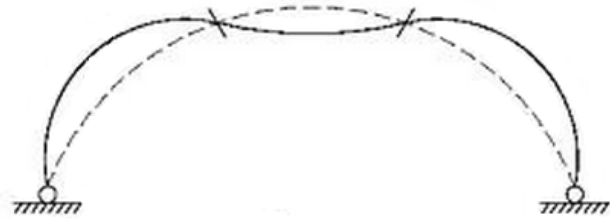
Figura 5-9 Ejemplo de deformación en arco
