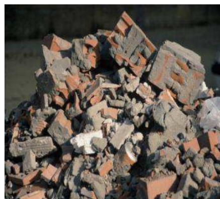
Fig. 4 “RCD generados en obras de reforma”. Fuente: el autor.
