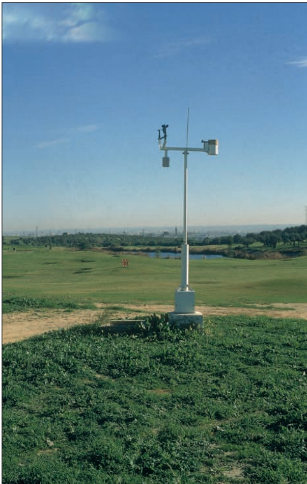
Estación meteorológica integrante de un sistema informatizado utilizado en un gran espacio con césped, concretamente en un campo de golf.
