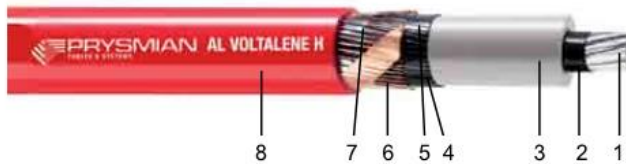
Figura II.4: Ejemplo de cable subterráneo (AL RHZ1-OL, fabricante Prysmian). (1) Conductor de Aluminio, (2) Semiconductora interna, (3) Aislamiento (polietileno reticulado, XLPE), (4) Semiconductora externa, (5) Protección longitudinal contra el agua, (6) Pantalla de cobre, (7) Separador, (8) Cubierta exterior de poliolefina termoplástica
