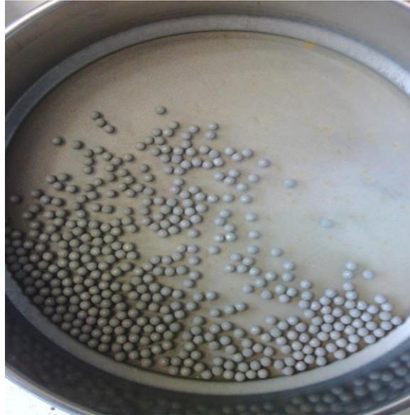
**Figura 4.6:** Tamiz con bolas del molino.
