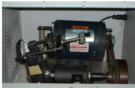
*Figura 2.10: Molino vibratorio SPEX 8000D Mixer Miller.*
