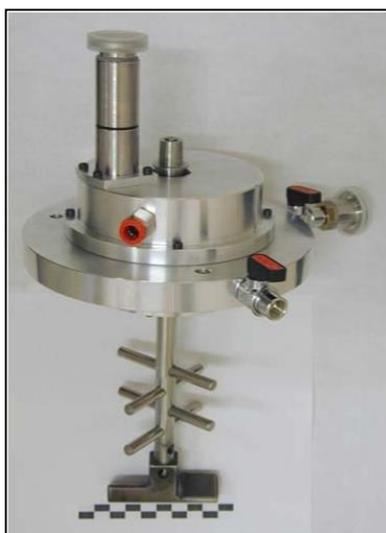
**Figura 4.4:** Tapadera para la realización de moliendas en atmósfera de Ar.
