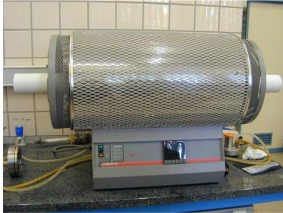
**Figura 4.16:** Horno tubular de alto vacío CARBOLITE HVT 15/50/450 utilizado para calentar a distintas temperaturas el polvo molido, para su posterior estudio de difracción de rayos X.
