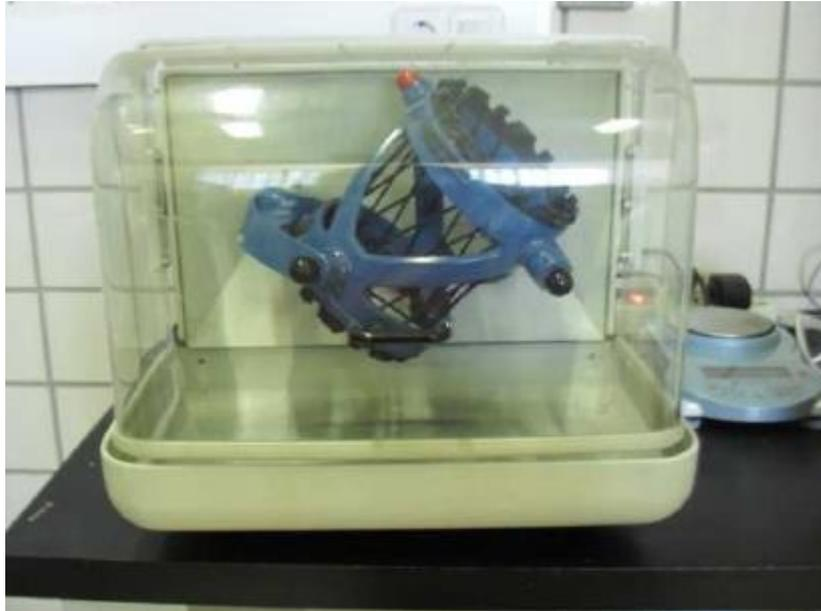
**Figura 4.1:** Molino mezclador TURBULA Type T2 C.
