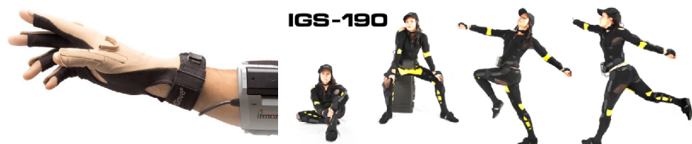
Figura 3.1 Guante (izquierda) y traje corporal (derecha) sensorizados.
