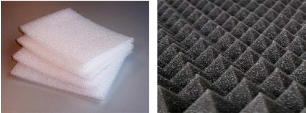
*Imágenes 13 y 14: Materiales porosos. Fuente: [www.asfaltex.com](http://www.asfaltex.com) e [www.ingeneriaacusticafacil.com](http://www.ingeneriaacusticafacil.com)*
