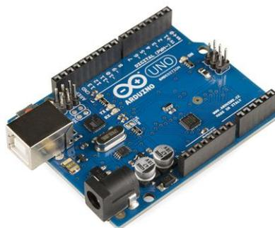
Figura 6-9. Plataforma Arduino uno.
