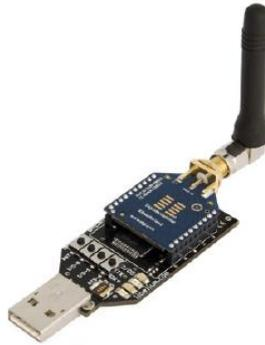
Figura 5-1. Wasmote gateway con transceptor XBee.
