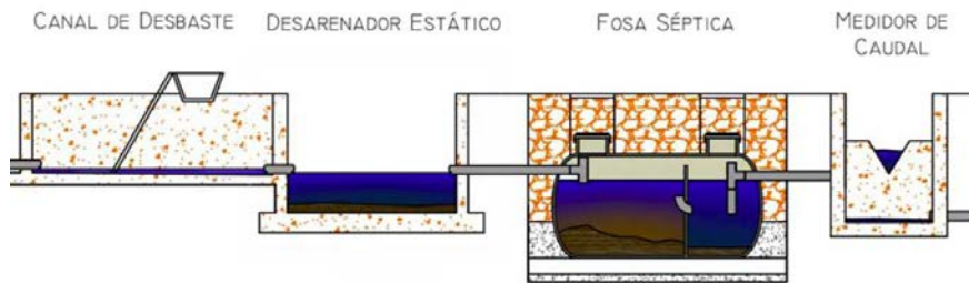
Fig.2. Diagrama de flujo de una fosa séptica. (CEDEX, 2010)
