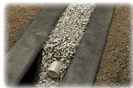
Fig.2. Imagen de dren filtrante.
