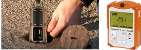
Fig.4. y 5. Geófonos (www.inspeccionestecnicas.es, 2015)
