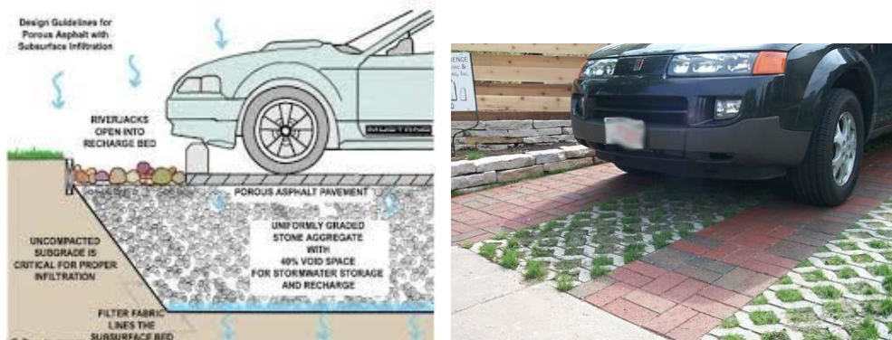
Fig.11 y 12. Aparcamiento con pavimento permeable en Ipswich (UK). (Susdrain)
