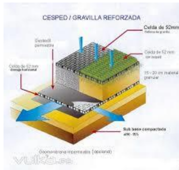
Fig.3. Detalle de superficie permeable continua reforzada
