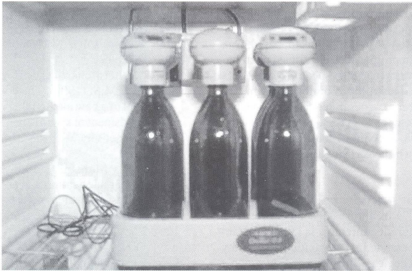
Fig.4. Sistema OXITOP IS6 WTW para la determinación de DBO.
