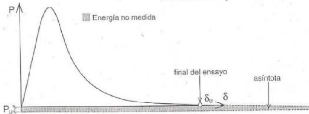
Ilustración 2.10: Energía de la cola que no se puede medir en un ensayo de flexión en tres puntos
