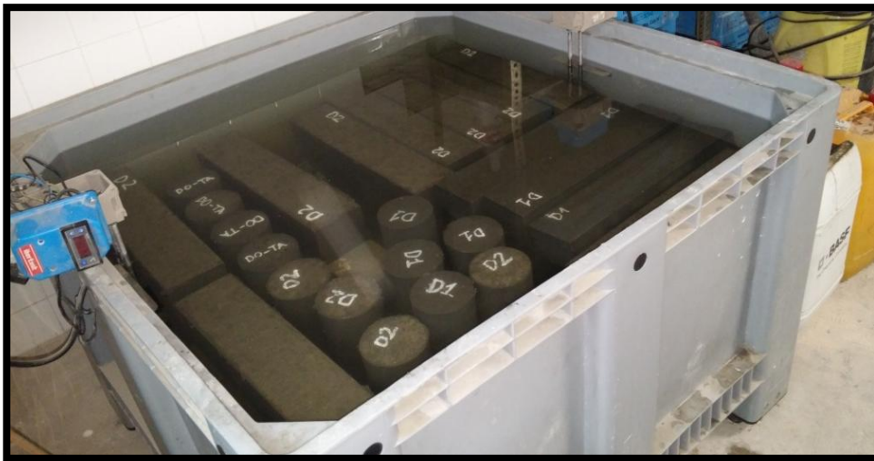
Ilustración 3.15: Fraguado del Hormigón
