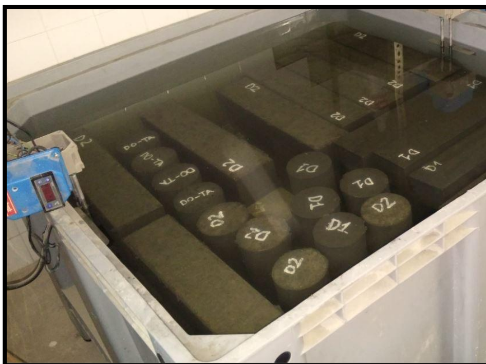
Ilustración 3.22: Curado del Hormigón
