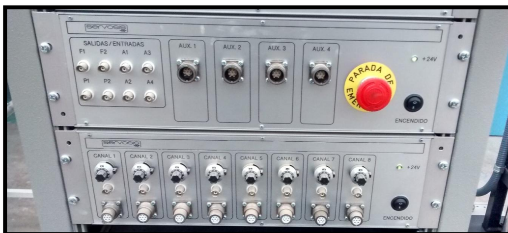
Ilustración 4.7: Canales, salidas/entradas, auxiliares y parada de emergencia
