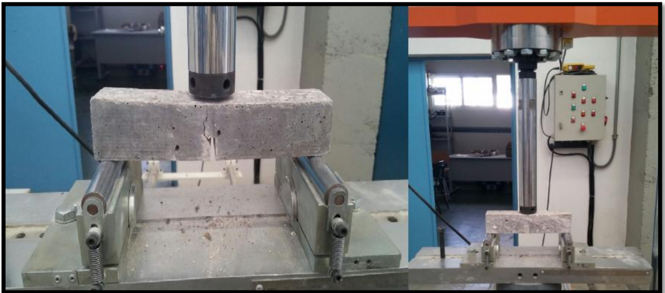
Ilustración 4.2: Ensayo de flexión en tres puntos.
