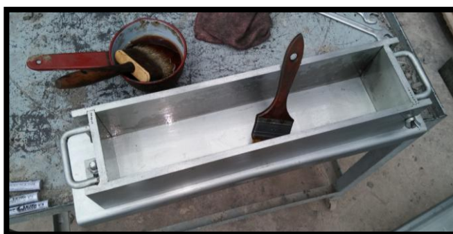
Ilustración 3.11: Molde cubierto de desencofrante
