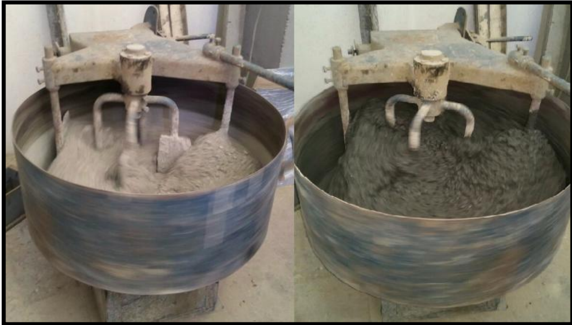
Ilustración 3.19: Mezclado de los Materiales. 1º Fase (Izq). 2ª Fase (Der)
