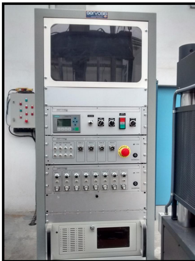
Ilustración 4.6: Panel de control Servosis para máquina de F3P y de compresión uniaxial
