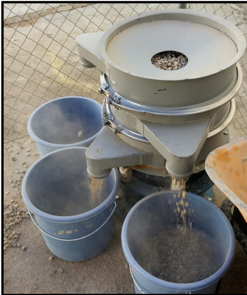
Ilustración 3.2: Tamizadora de Grava (tamices de 2 y 10 mm)
