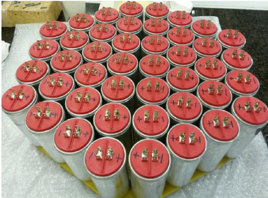
Figura 1–26. Banco de condensadores atornillados a la base hexagonal
