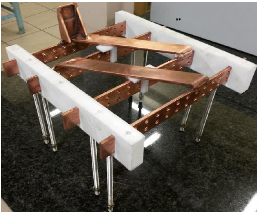
Figura 1–28. Barras de conexión de los condensadores
