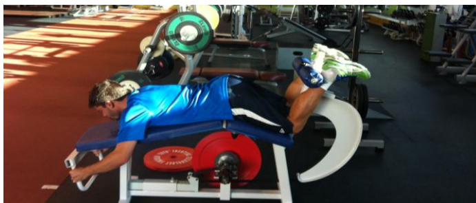
Figura 1. Dispositivo isoinercial para leg curl (yoyo® Technology AB, Estocolmo, Suecia) descrito en la metodología.
