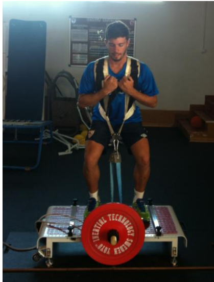
Figura 2. Dispositivo isoinercial para ½ squat (yoyo® Technology AB, Estocolmo, Suecia) descrito en la metodología.
