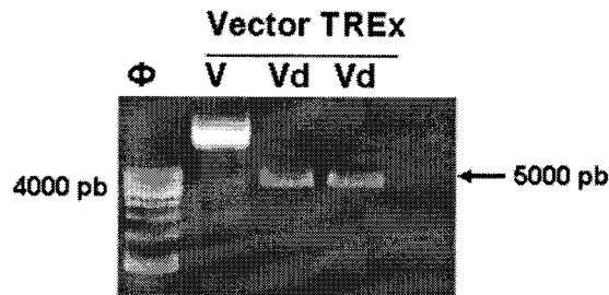
Figura 46. Análisis por electroforesis de la digestión del vector TREx (Vd). Se utilizó como control vector sin digerir (V), así como marcadores de tamaño para el ensayo (Φ).
