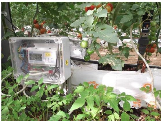
*Figura 2. Imagen de un equipo para controlar el fertirriego con abonos químicos de síntesis en horticultura bajo invernadero.*
