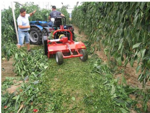
**Figura 4.** Picado de restos vegetales de un cultivo de pimiento en invernadero. En este caso se ha utilizado una picadora de martillos.
