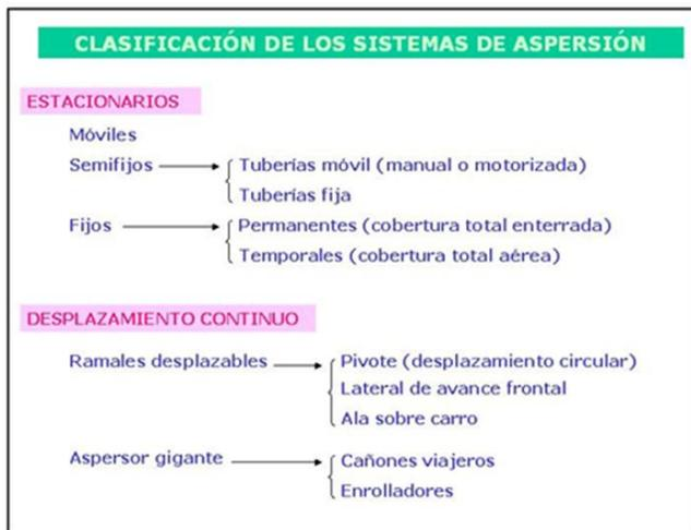
*Figura 1. Clasificación de los principales sistemas de riego por aspersión.*
