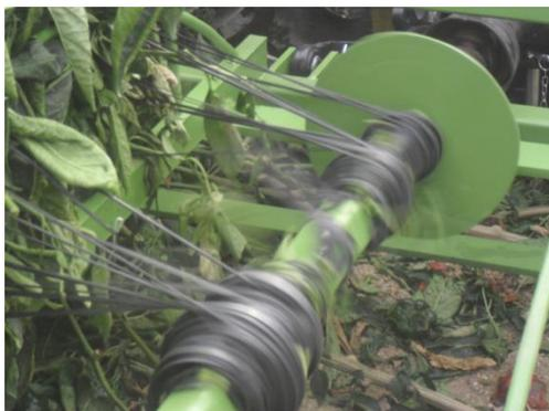
**Figura 3.** Máquina bobinadora retirando hilo de rafia de un cultivo de pimiento en invernadero.
