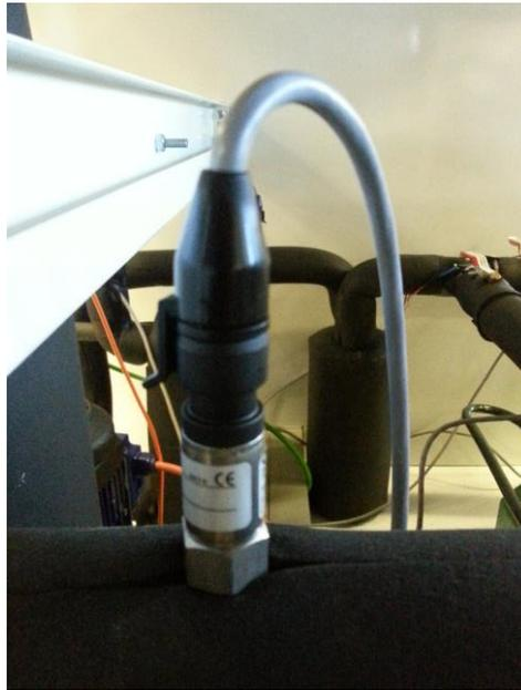
Figura 2.21. Imagen de la sonda de presión a la salida del evaporador asociado al recinto de 5°C
