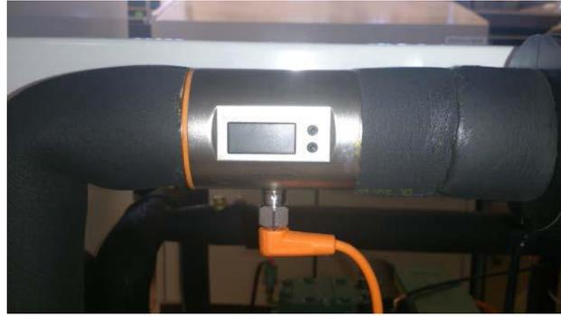
Figura 2.17. Imagen de uno de los caudalímetros instalados
