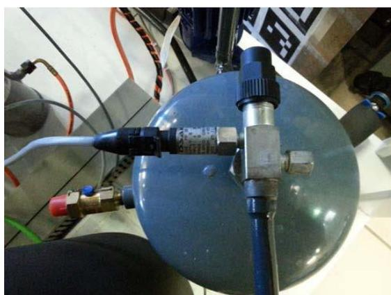
Figura 2.20. Imagen de la sonda de presión OSAKA a la salida del condensador
