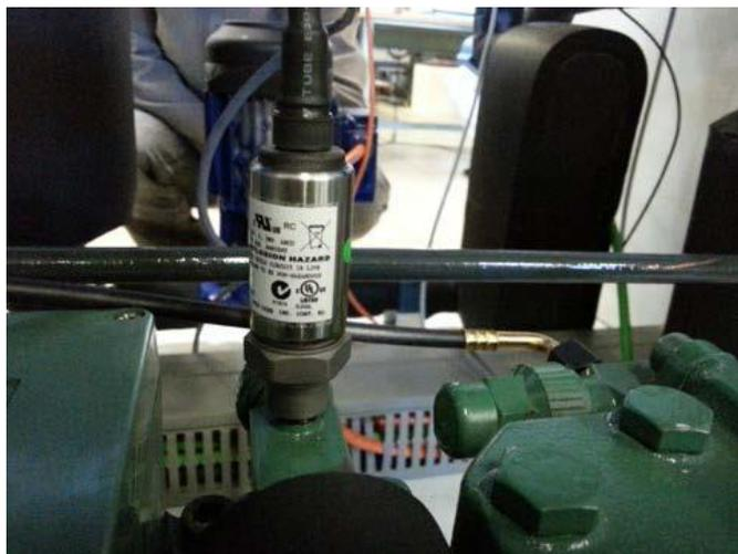
Figura 2.19. Imagen del transductor de presión de la casa Johnson Controls
