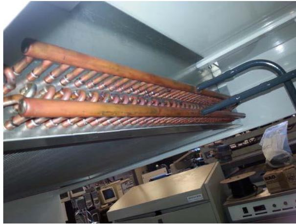
Figura 2.10. Imagen del condensador de aire
