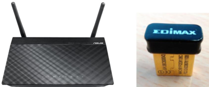
Figura 3.3: A la izquierda dispositivo router *ASUS DSL-N12E 5375*, a la derecha adaptador WiFi.
