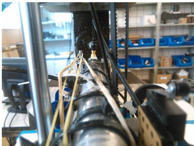
Figura 3-11. Detalle de gomillas de compensación
