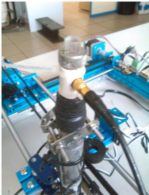
Figura 3-9. Detalle de la sujeción del palpador 1
