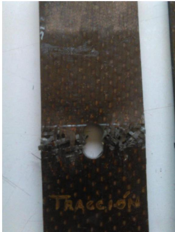
Figura 5-1. Probeta ensayada a tracción
