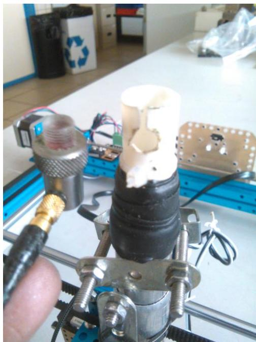
Figura 3-10. Detalle de la sujeción del palpador 2
